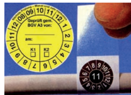
Bild 8-1: Beispiele von Prüfplakette/-banderole zur Dokumentation an elektrischen Arbeits-/Betriebsmitteln
