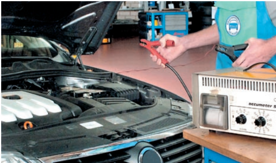
Bild 4-1: Vorbereitung zur Ladung der Batterie in einem Personenkraftwagen
