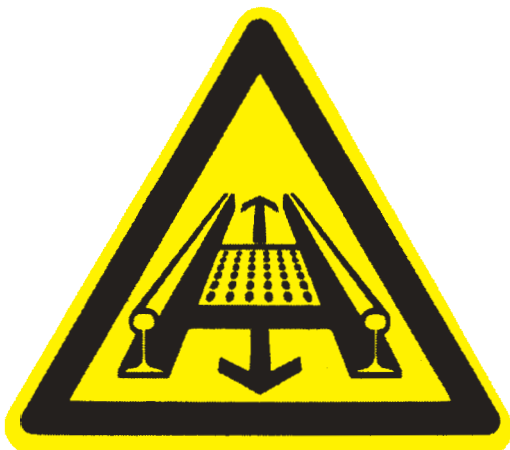
W29 Warnung vor Gefahr durch eine Förderanlage mit Gleis
