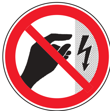
P09 Nicht berühren, Gehäuse unter Spannung
